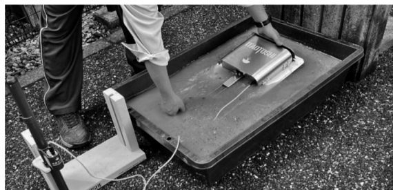
写真-3 水害時冠水を想定した泥水浸水試験
